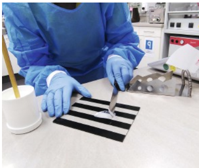
Endkontrolle Beim Ausstreichen auf einer Glasplatte muss die fertige Creme homogen und klumpenfrei sein.
