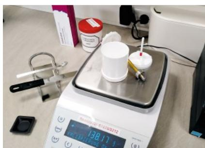
**Vorbereitung** Zunächst werden alle Ausgangsmaterialien bereitgestellt. Dann wird die Drehdosierkrucke tariert und Clobetasolpropionat auf der Analysenwaage abgewogen.
