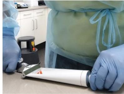
**Abfüllen** In einer Tube mit Innenschutzlackierung ist das photoinstabile Simvastatin vor Licht geschützt.
